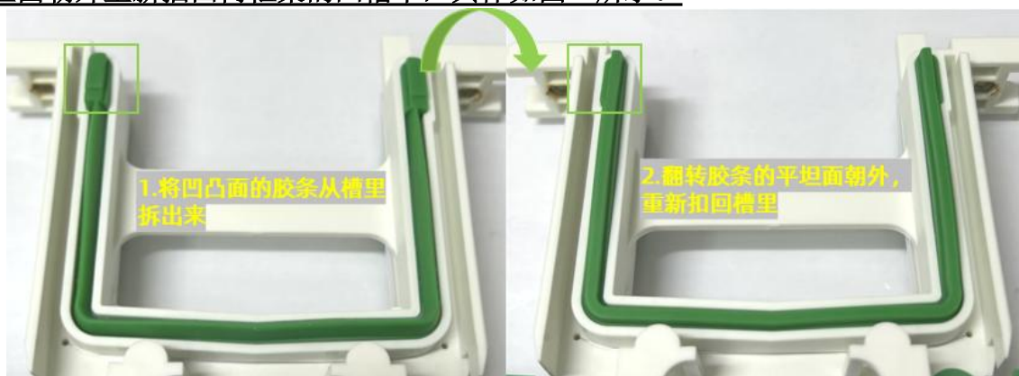
图4 电泳卡槽胶条更换示意图
